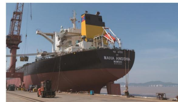
安装脱硫塔后的印度船
